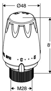
**Begränsad termostat med direktanslutning till MMA ventildelar**
